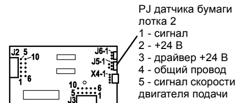
Рисунок 5 PWB управления лотка
