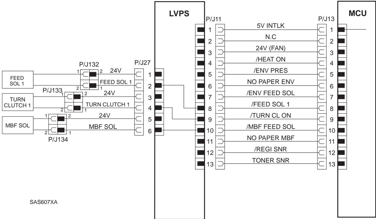
2. LVPS ↔ FEED SOLENOID 1, TURN CLUTCH, AND MBF SOLENOID
