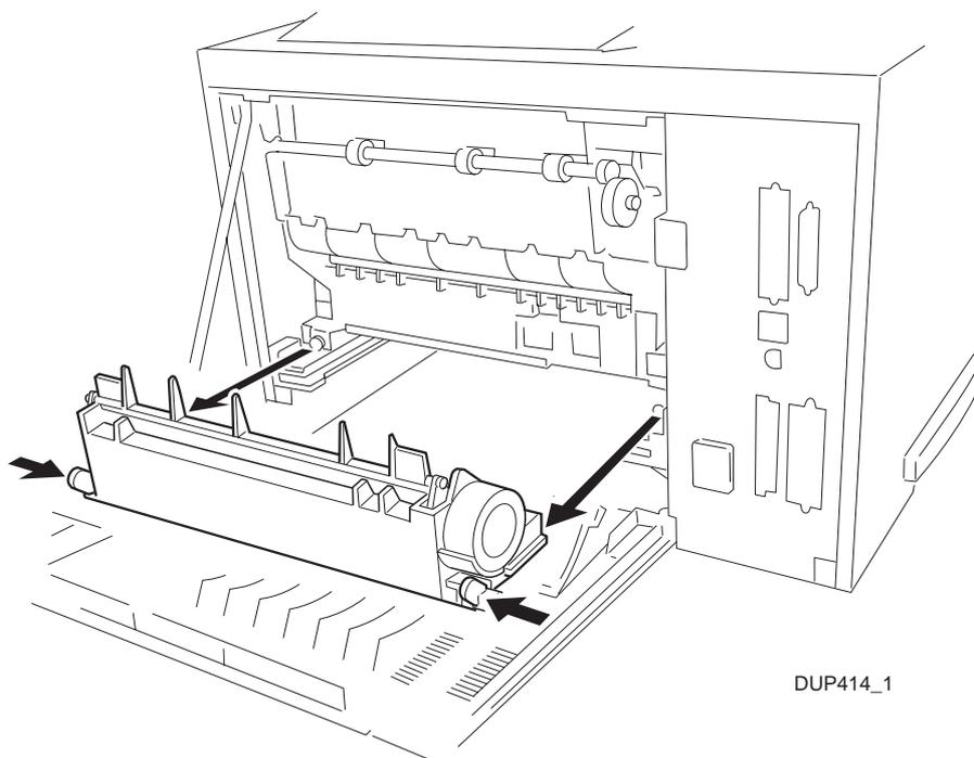
Figure 10.3.1.1 Duplex Module Removal
